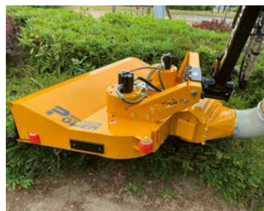
Een snoeibak hangt altijd uit balans, anders dan bij een sorteergriper. Door de onbalans was extra aandacht nodig voor de lagers en assen in de rotator.
